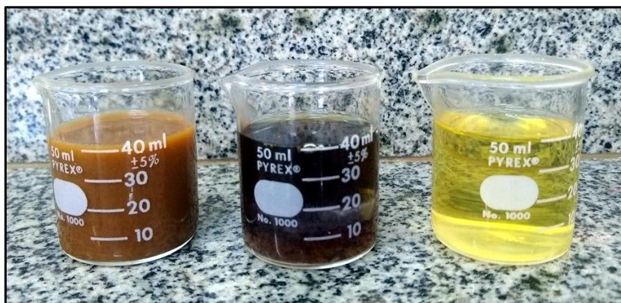
**Figura 3.19** – Da esquerda para a direita: amostra de Caldo Misto, Caldo Tratado e Caldo Clarificado para leitura do POL
