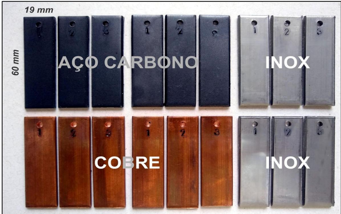
**Figura 2.10** – Lâminas de prova em aço carbono, cobre e inox com dimensões 60 x 19 mm para o estudo de incrustação
