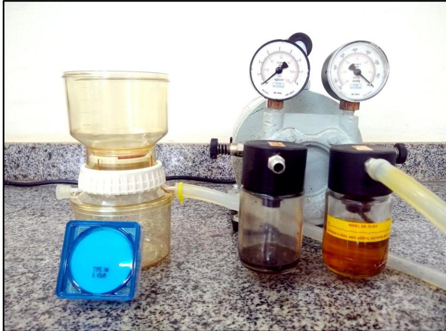
**Figura 2.9** – Sistema para filtração à vácuo. Bomba de Vácuo Modelo 132 (Prismatec, Itú/SP), Filter Holder (Millipore, USA) e filtro de membrana HA 0.45 nitrocelulose (Millipore, USA)
