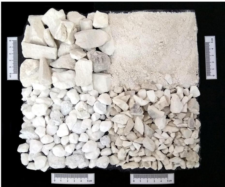
**Figura 2.1** – Aspecto físico das amostras de Cal obtidas para análise. Escala das réguas em centímetro
