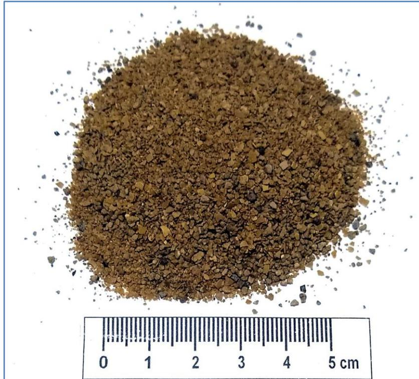
**Figura 2.18** – Amostra de incrustação padronizada utilizada nos estudos de dissolução
