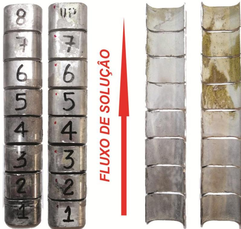
**Figura 2.15**– Secção de tubo incrustado, vista exterior e interior. A seta demonstra o sentido do fluxo de solução através do tubo e sua posição vertical
