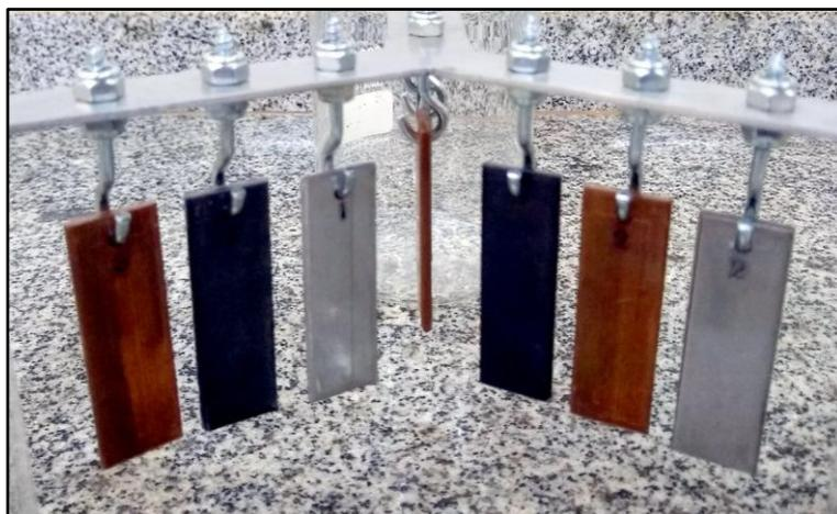
**Figura 2.13** – Detalhe do Suporte do Corpos de Prova do Sistema de Ensaios Preliminares de Incrustação
