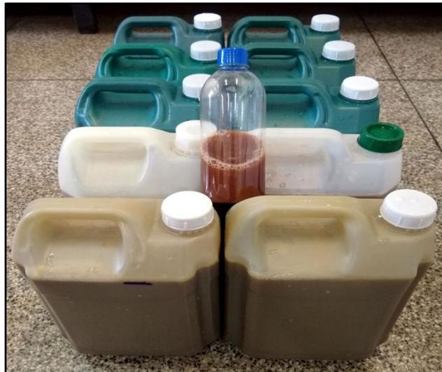
**Figura 2.14** – Amostras de Caldo de Cana padronizado e fracionado utilizado no Estudo de Incrustação
