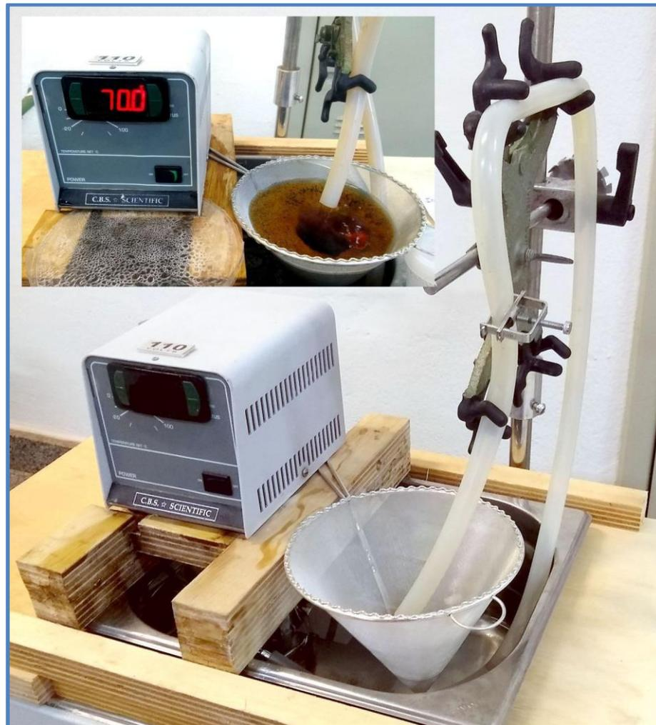
**Figura 2.16** – Montagem utilizada no estudo de dissolução de incrustações. Sistema composto por cuba de armazenamento de solução com capacidade de 6 litros, bomba para circulação / aquecedor microprocessado (Polyscience Model 71- USA) e suporte em inox para a incrustação em estudo
