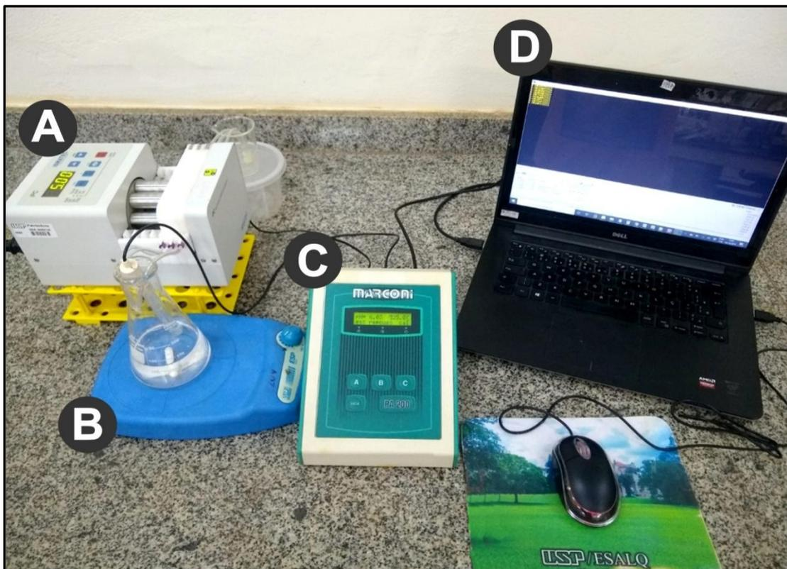
**Figura 2.4** – Setup para execução do estudo cinético de neutralização. A = bomba peristáltica IPC; B = agitador magnético ESP; C = pHmetro digital com saída serial PA 200; D = PC para registro leituras de pH
