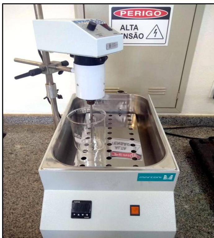
**Figura 2.7** – Montagem para o preparo da suspensão de Leite de Cal. Banho Maria Termostatzado MA 156 e Agitador Mecânico TE-039
