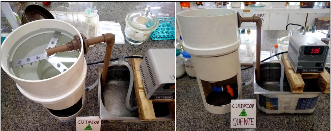
**Figura 2.12** – Imagem do Sistema de Ensaios de Incrustação
