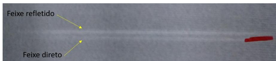
Figura 4.11. Imagem captada durante ajuste da reflexão total, onde é possível ver o feixe refletido e o feixe que passa direto sem contato com o substrato refletor
