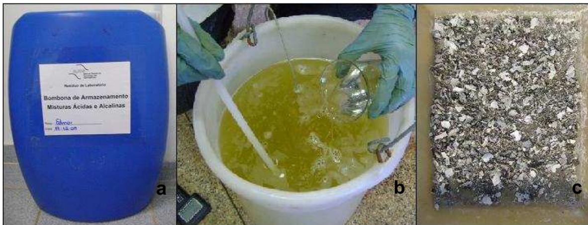
**Figura 18** – Propostas para o gerenciamento de soluções ácidas ou alcalinas sendo em a) bombona para armazenamento de misturas ácidas ou alcalinas; b) neutralização em baldes de 20 L; c) resíduo contendo ligas de Raney e Devarda secos sob irradiação solar
