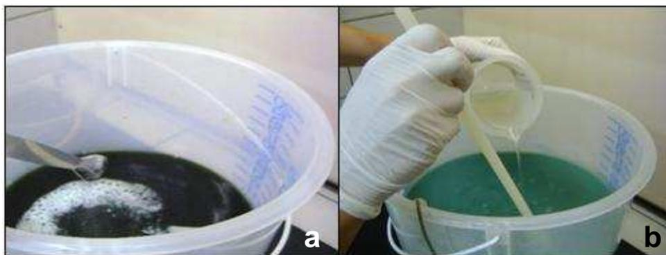
**Figura 19** – Tratamento do resíduo de dicromato de potássio sendo em a) redução do Cr (VI) com  $\text{NaHSO}_3$ ; b) remoção do Cr (III) com NaOH
