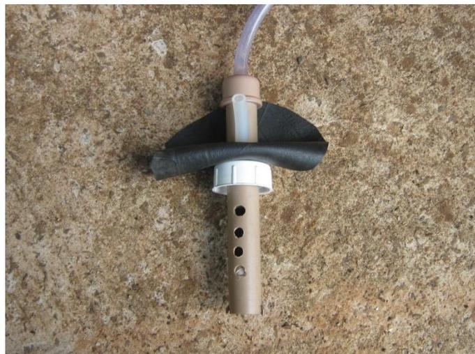
Figura 4 – Fotografia do sistema limitador de volume de coleta de água
