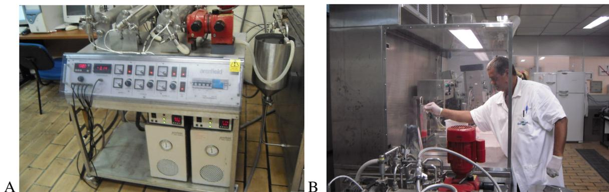
**Figura 9** - A. Pasteurizador utilizado no tratamento das polpas de camu-camu. B. Envase das polpas pasteurizadas. Crédito das Fotos do próprio autor.
