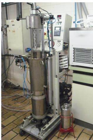
**Figura 10** - Equipamento utilizado na pressurização das polpas de camu-camu
