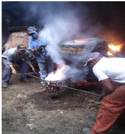
Figura 1.1: Trabalhadores em uma pequena indústria de fundição recolhendo do forno o material fundido (bronze) para a moldagem, onde a alta concentração de elementos provavelmente tóxicos é evidente, podendo-se visualizar dois deles sem protetores nasais e manuais.
