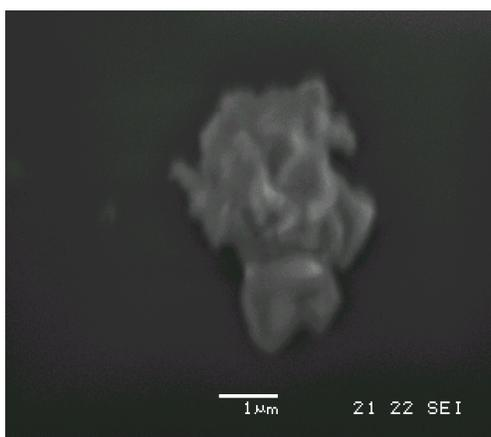
Figura 5.8: Imagem obtida com microscópio eletrônico de varredura em modo elétrons secundários – particulado grosso.
