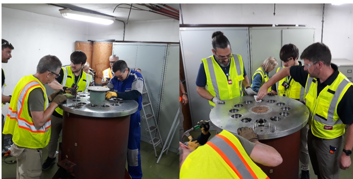
Figura 4. Desparafusamento da tampa da blindagem (à esquerda) e ‘wipe test’ (à direita) para verificar se haveria vazamento de material radioativo das fontes seladas.
