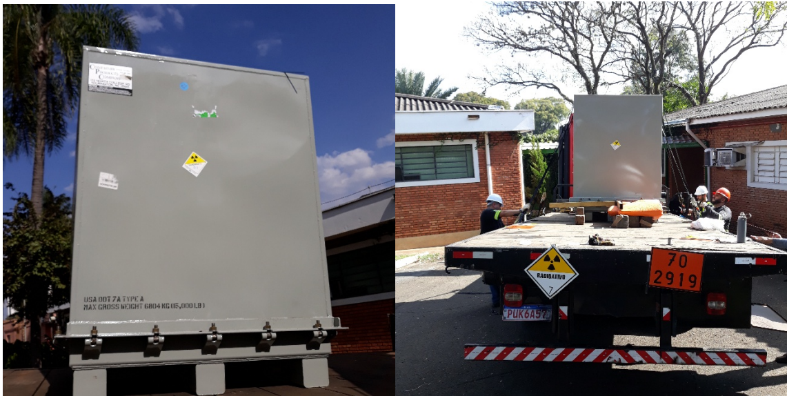
Figura 14. Caixa de contenção selada sobre o guindauto para a viagem das fontes até o destino final em Belo Horizonte, Minas Gerais.
